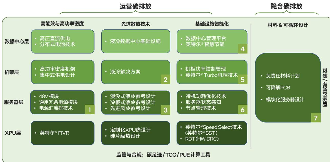
图6 英特尔中国绿色数据中心技术框架 2.0
