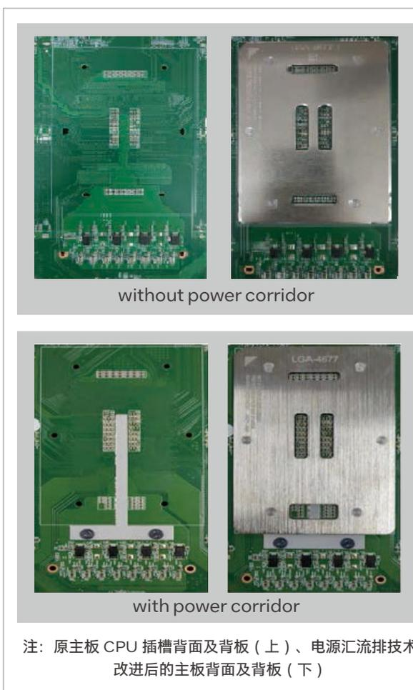
图 23 烽火超微应用电源汇流排技术的主板 CPU 插座背面的前后对比图
