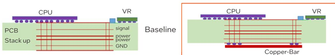
图 8 传统提升供电布线方法 (左) 与电源汇流排技术提升供电布线方法 (右)
