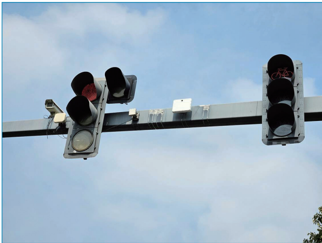
图 7. 部署于交通路口信号灯杆上的雷视一体机
